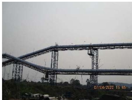
รูปที่ 12 ระบบสายพานลำเลียงแบบปิดครอบ
