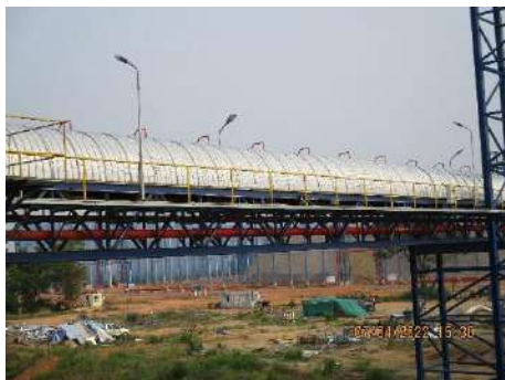
รูปที่ 12 ระบบสายพานลำเลียงแบบปิดครอบ
