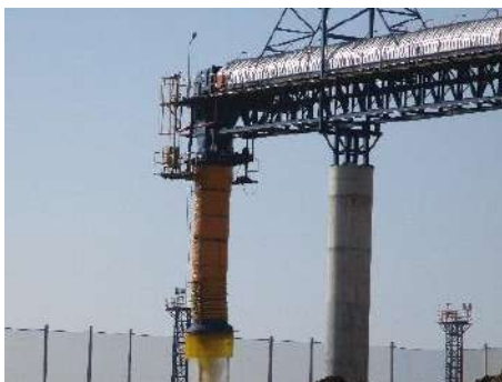
รูปที่ 26 ครอบกันฝุ่นฟุ้งกระจาย
