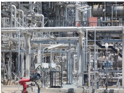
รูปที่ 2-39 การวางท่อบน Pipe Rack หรือ Pipe Bridge ในลักษณะที่ปลอดภัย
