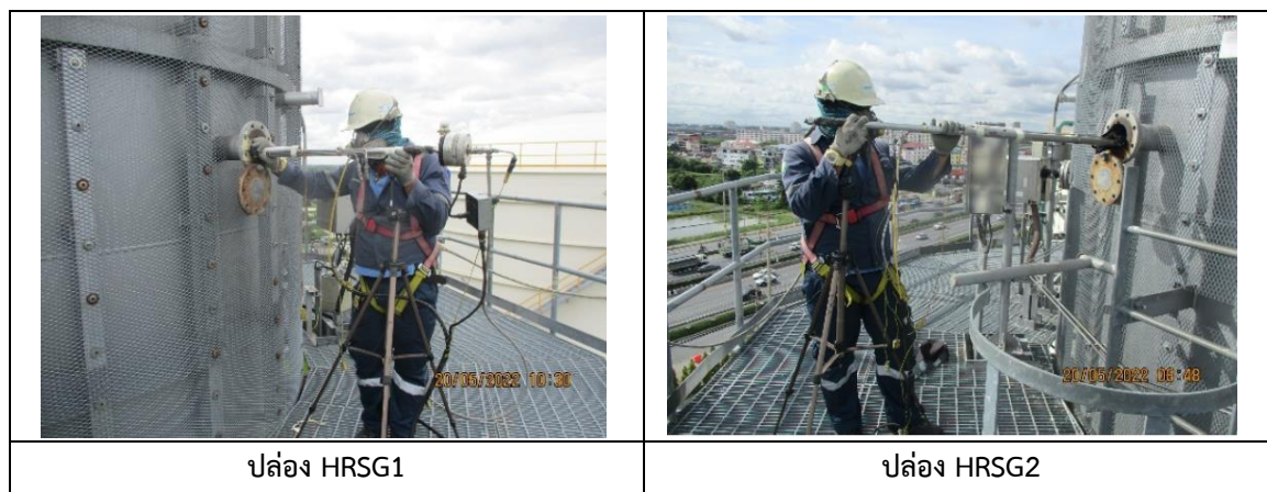
ภาพที่ 3.2-2 : การเก็บตัวอย่างอากาศจากปล่องระบาย HRSG1 และปล่อง HRSG2 ของโครงการ เมื่อวันที่ 20 พฤษภาคม 2565
