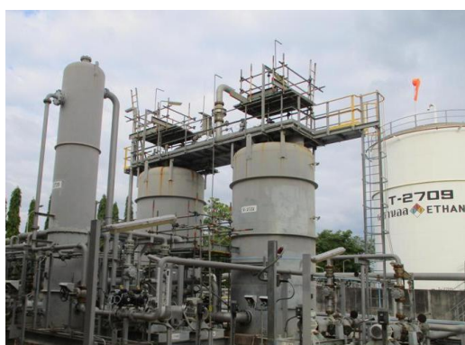
รูปที่ 3-8 Vapor Recovery Unit (VRU)
