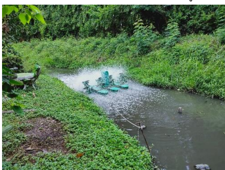
ภาพที่ 2-13 เครื่องเติมอากาศในบ่อพักน้ำทิ้ง
