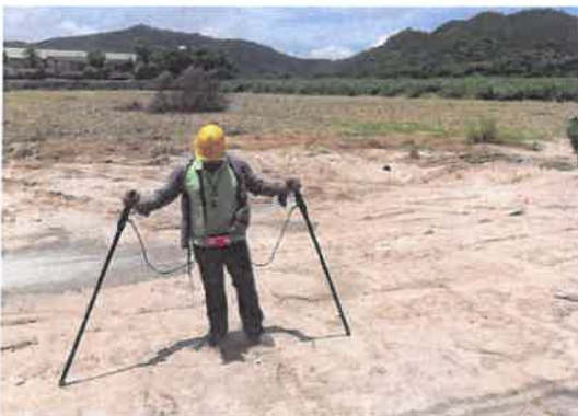
รูปที่ 2-12 การตรวจสอบแนวท่อด้วยอุปกรณ์ DCGV
