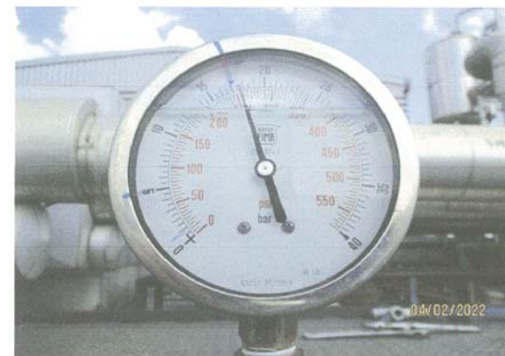
ทำการตรวจความดันที่ใช้ในการอัดเพื่อทำHydrostatic test 1.0 เท่าของ Max Allowable Working Pressure ความดันที่ใช้ 17 Bar ทดสอบที่ความดัน 17 Bar หม้อไอน้ำหมายเลข Aux Boiler ( 00QHB10BB001) บริษัท ราชบุรีเวิลด์ โคเจนเนอเรชั่น จำกัด. วันที่ 4 กุมภาพันธ์ 2565
