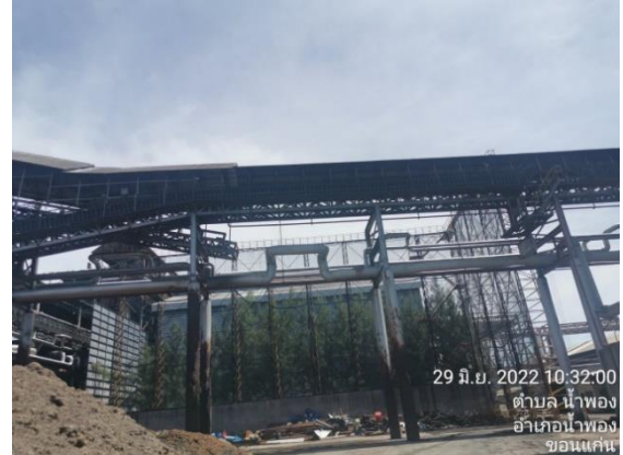
รูปที่ 17 ระบบสายพานลำเลียงเชื้อเพลิง
