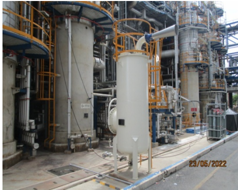
ปล่อง Charcoal Adsorber แบบเคลื่อนที่ รูปที่ 3-4 ปล่องระบายอากาศของโครงการ (ต่อ)
