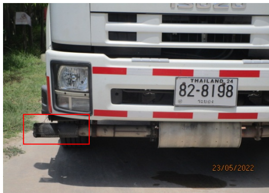
รูปที่ 3-48 อุปกรณ์ป้องกันประกายไฟที่ท่อไอเสีย
