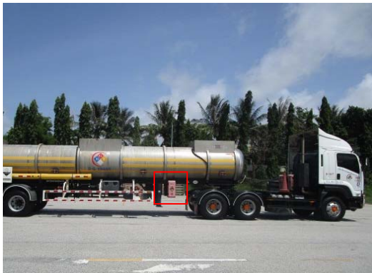
รูปที่ 3-42 ถังดับเพลิงที่รถขนส่ง
