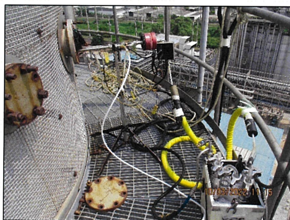
ภาพถ่ายที่ 3.5.1.4-1 ขณะดำเนินการตรวจวัดคุณภาพอากาศจากปล่อง HRSG#4 (CTG#4)
