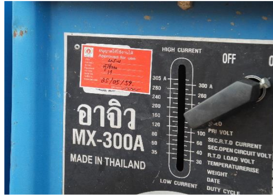
รูปที่ 2-50 นำระบบสติ๊กเกอร์สี (Color Code) มา ใช้ในโครงการเพื่อระบุระยะเวลาที่ได้ดำเนินการ ตรวจสอบสภาพเครื่องมือ เครื่องจักร และอุปกรณ์ การก่อสร้าง
