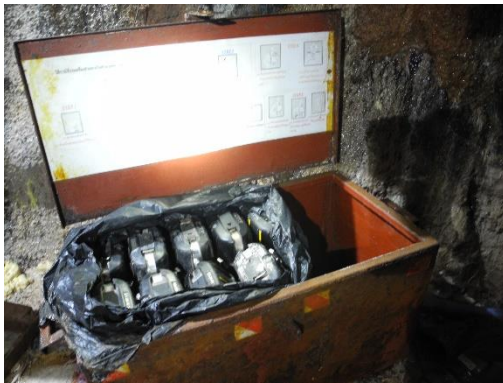
รูปที่ 2-81 ชุดอุปกรณ์ SCSR อยู่ห่างจากหน้างาน ไม่เกิน 10 เมตร
