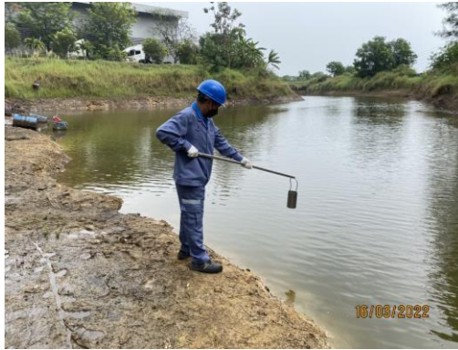
รูปที่ 3.4-25 การเก็บตัวอย่างคุณภาพน้ำในบ่อกักน้ำทิ้งของโครงการ (Oxidation Pond) บ่อน้ำขนาด 454 ลบ.ม.
