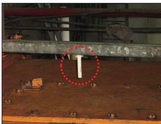
รูปที่ 2-19 อุปกรณ์ตรวจจับความร้อน
