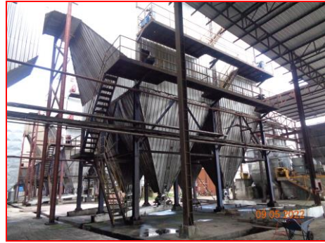
ภาพที่ 2.2-6 อุปกรณ์ดักฝุ่น แบบ Electrostatic Precipitator
