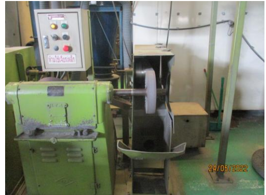
รูปที่ 38 เครื่องสกัดกลมแท่นหินเจียร สำหรับตัดเจียรชิ้นงานของแผ่นก Finishing
