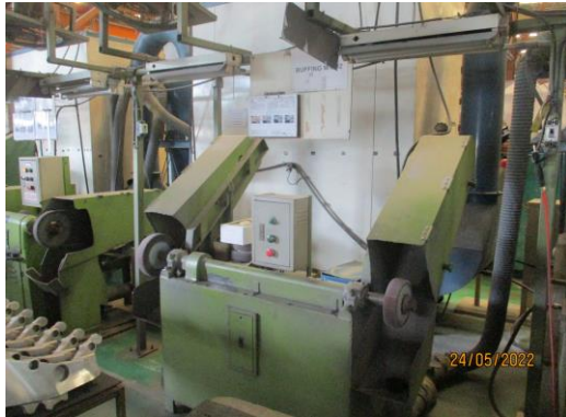
รูปที่ 38 เครื่องสกัดกลมแท่นหินเจียร สำหรับตัดเจียรชิ้นงานของแผ่นก Finishing
