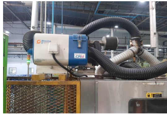
รูปที่ 2 เครื่องกักเก็บละอองน้ำมัน
