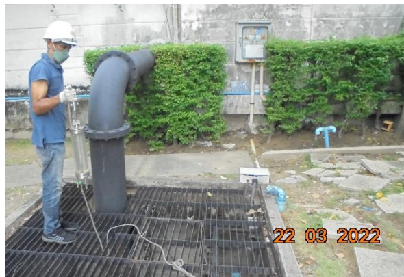
รูปที่ 2-19 การเก็บตัวอย่างน้ำจากระบบบำบัดน้ำเสีย
