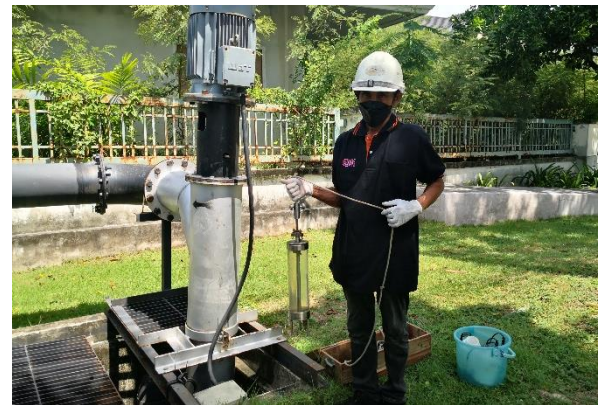
รูปที่ 2-19 การเก็บตัวอย่างน้ำจากระบบบำบัดน้ำเสีย
