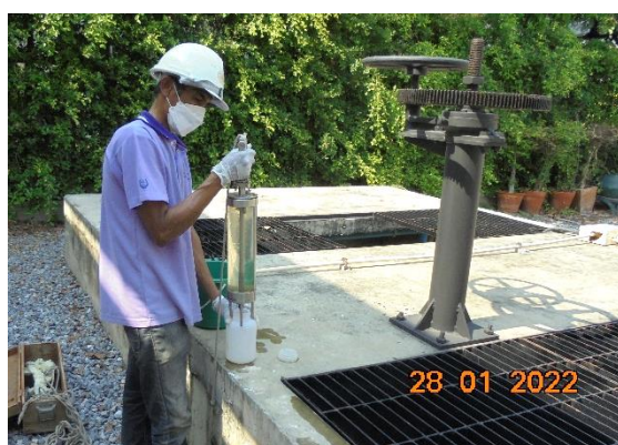
รูปที่ 2-25 การเก็บตัวอย่างน้ำจากระบบบำบัดน้ำเสียรวมส่วนกลาง
