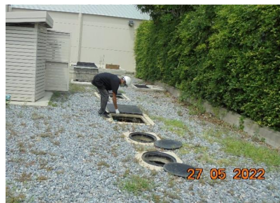
รูปที่ 2-25 การเก็บตัวอย่างน้ำจากระบบบำบัดน้ำเสียรวมส่วนกลาง
