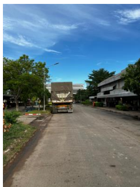
รูปที่ 2 รถบรรทุกขนส่งวัสดุก่อสร้างที่มีการปิดคลุมผ้าใบอย่างมิดชิด
