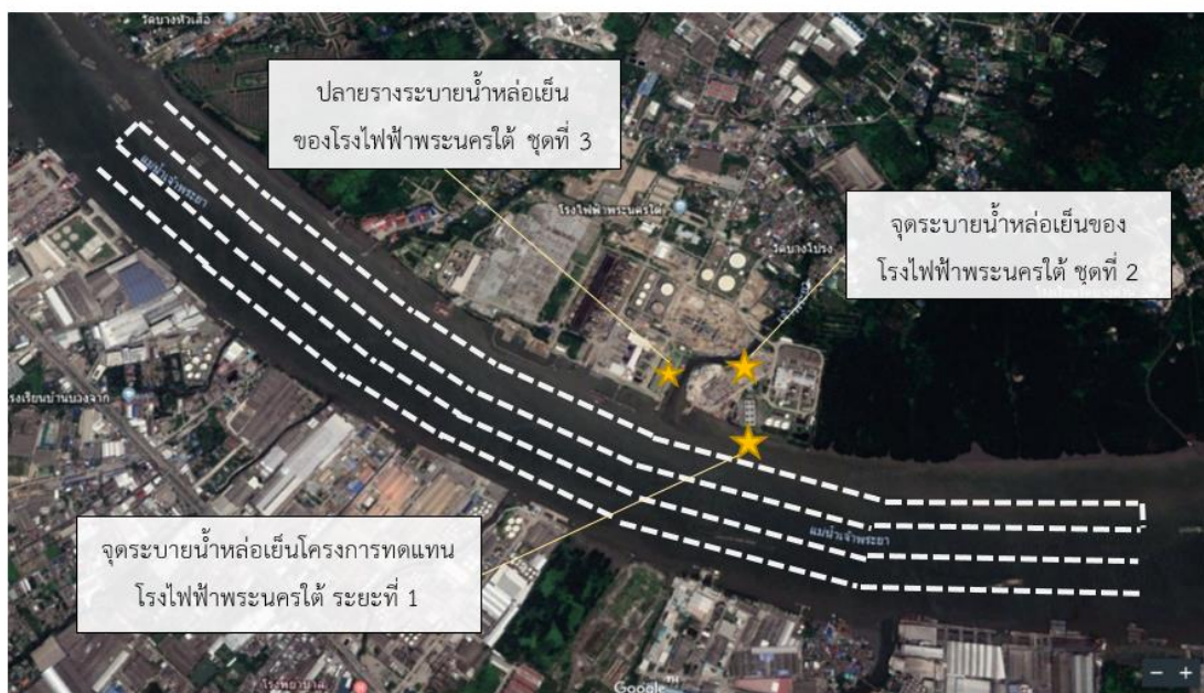
รูปที่ 3.20 แผนที่เส้นทางการตรวจวัดการแพร่กระจายอุณหภูมิน้ำหล่อเย็นในแม่น้ำเจ้าพระยา
