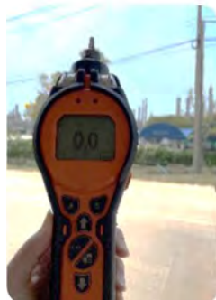
พนักงานทำการตรวจวัดรอบพื้นที่โครงการ ด้วยเครื่องวัด TVOC และ BZ/BD
