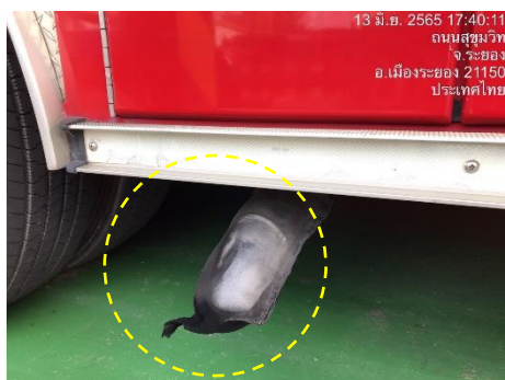
ภาพที่ 2-89 ท่อป้องกันประกายไฟ
