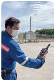
พนักงานทำการตรวจวัดรอบพื้นที่โครงการ ด้วยเครื่องวัด TVOC และ BZ/BD
