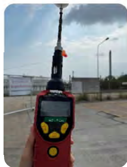
พนักงานทำการตรวจวัดรอบพื้นที่โครงการ ด้วยเครื่องวัด TVOC และ BZ/BD
