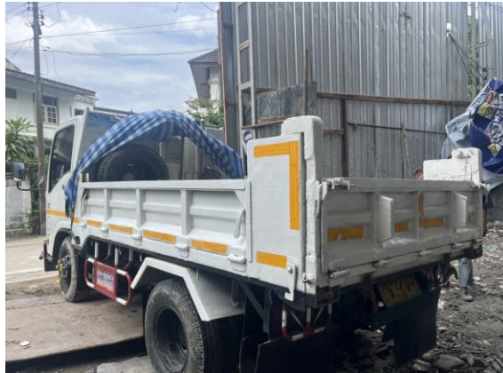
รูปที่ 39 การติดตั้งป้ายสะท้อนแสงและธงสีบริเวณท้ายรถ
