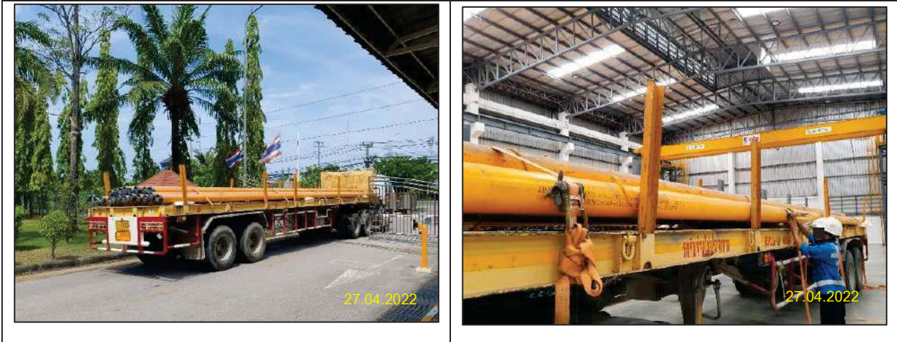
รูปที่ 2-4 การผูกมัดวัสดุอุปกรณ์รถบรรทุกขณะขนย้ายวัสดุ
