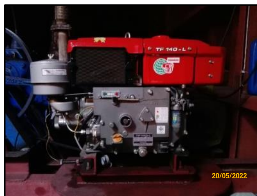
ภาพที่ 2.51 เครื่องปั่นไฟพร้อมสายไฟและ ปลั๊กไฟภายในเรือลำเลียงสินค้า
