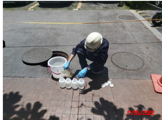
บ่อพักน้ำสุดท้ายของระบบบำบัดน้ำเสียเบื้องต้น อาคารชุดพักอาศัย
