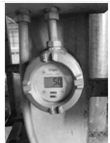
ขณะทำการสอบเทียบที่ Span ก่อนปรับ และหลังปรับ
