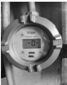
ขณะทำการสอบเทียบที่ Zero ก่อนปรับ และหลังปรับ
