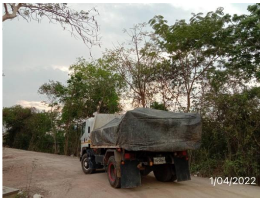
รูปที่ 3.2-3 การปิดคลุมวัสดุในการก่อสร้างเมื่อมีการขนย้าย
