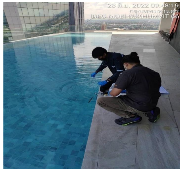
ภาพที่ 4.5-2 การตรวจวัด Total Coliform Bacteria (TCB) และ Fecal Coliform Bacteria (FCB) สระว่ายน้ำ
