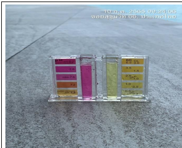
ภาพที่ 24 ตรวจค่า pH และ CL ของสระว่ายน้ำ
