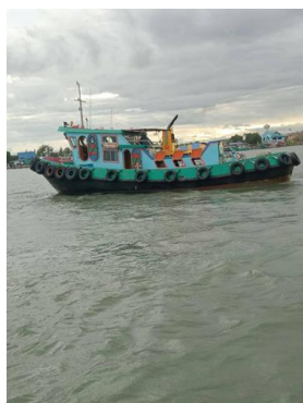
ภาพที่ 2-13 เรือท้องแบนสำหรับสำรวจคราบน้ำมันกรณีเกิดเหตุฉุกเฉิน
