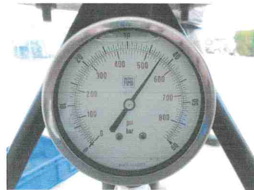
รูปที่ 4 การทดสอบการระบาย / POP TEST
