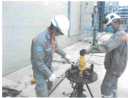
รูปที่ 2 การทดสอบอุปกรณ์นํ้ารั่ว
