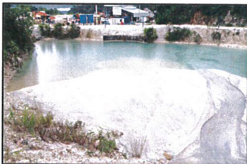
(45) อ่างดักตะกอนที่ 11 ข้าง Stock G ขนาดความจุ 4,900 ลบ.ม.
