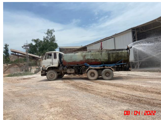
รูปที่ 2-8 การฉีดพรมน้ำบริเวณโรงโม่หิน และเส้นทางลำเลียงหิน
