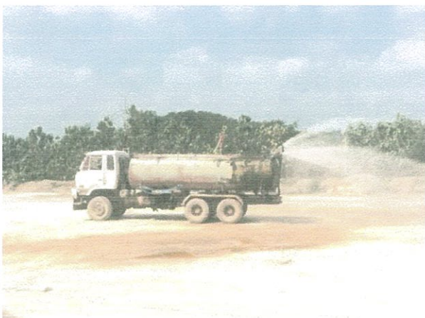
รูปที่ 20 รถบรรทุกน้ำฉีดพรมบริเวณโรงโม่หิน
