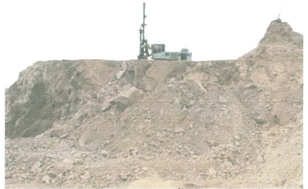
รูปที่ 4 เครื่องเจาะหินพร้อมระบบดูดฝุ่น
