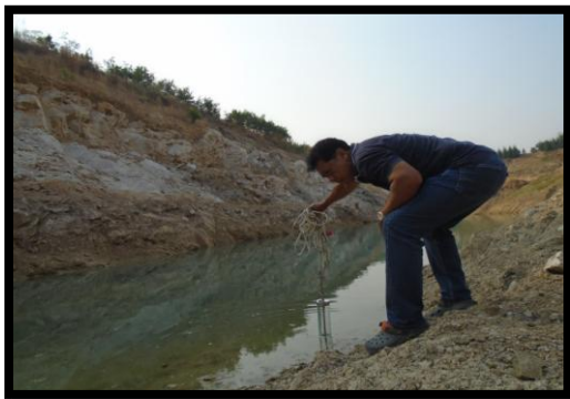
รูปที่ 2-10 การเก็บตัวอย่างน้ำบ่อเหมือง
