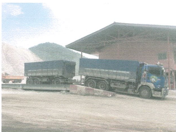
รูปที่ 24 ให้อลูมิเนียมปิดคลุมผ้าใบ เพื่อลดฝุ่นละอองจากการขนส่ง
