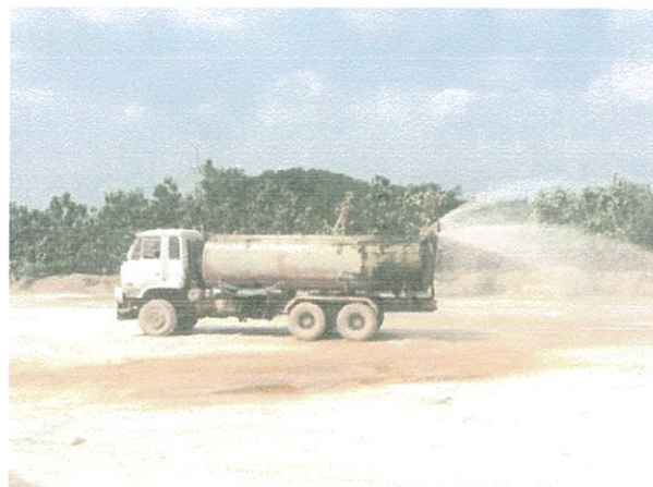
รูปที่ 22 รถบรรทุกน้ำฉีดพรมบริเวณโรงโม่หิน
