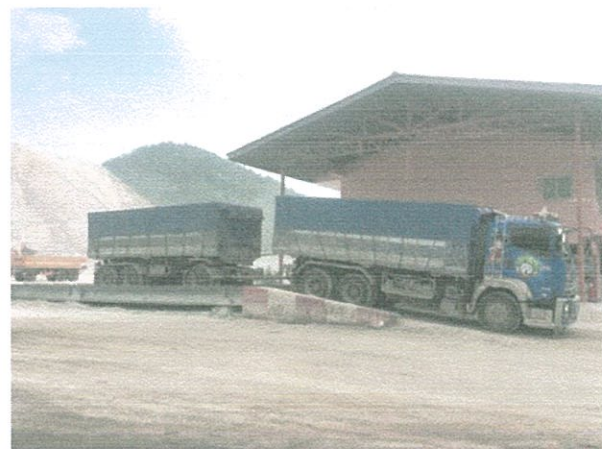
รูปที่ 24 ให้อุปกรณ์ปิดคลุมผ้าใบ เพื่อลดฝุ่นละอองจากการขนส่ง
