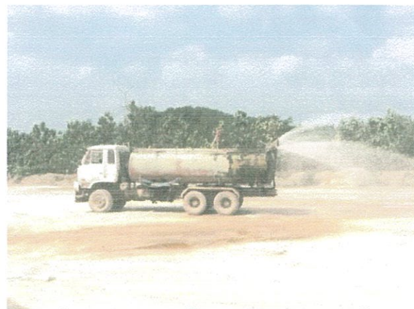
รูปที่ 22 รถบรรทุกน้ำฉีดพรมบริเวณโรงไม้หิน
