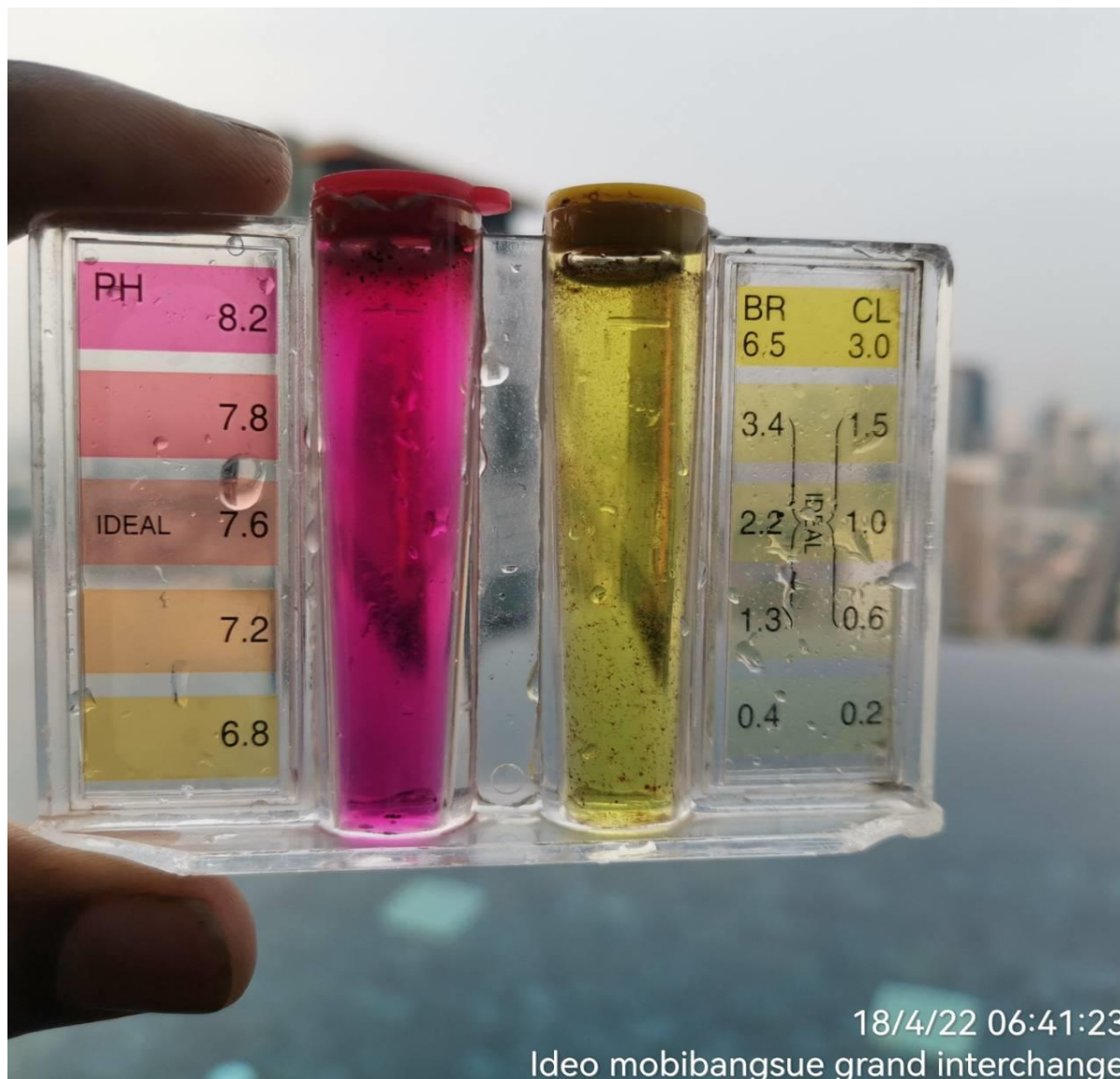
ภาพที่ 4.5-1 การตรวจวัด pH และ Free Chlorine ระบายน้ำ
