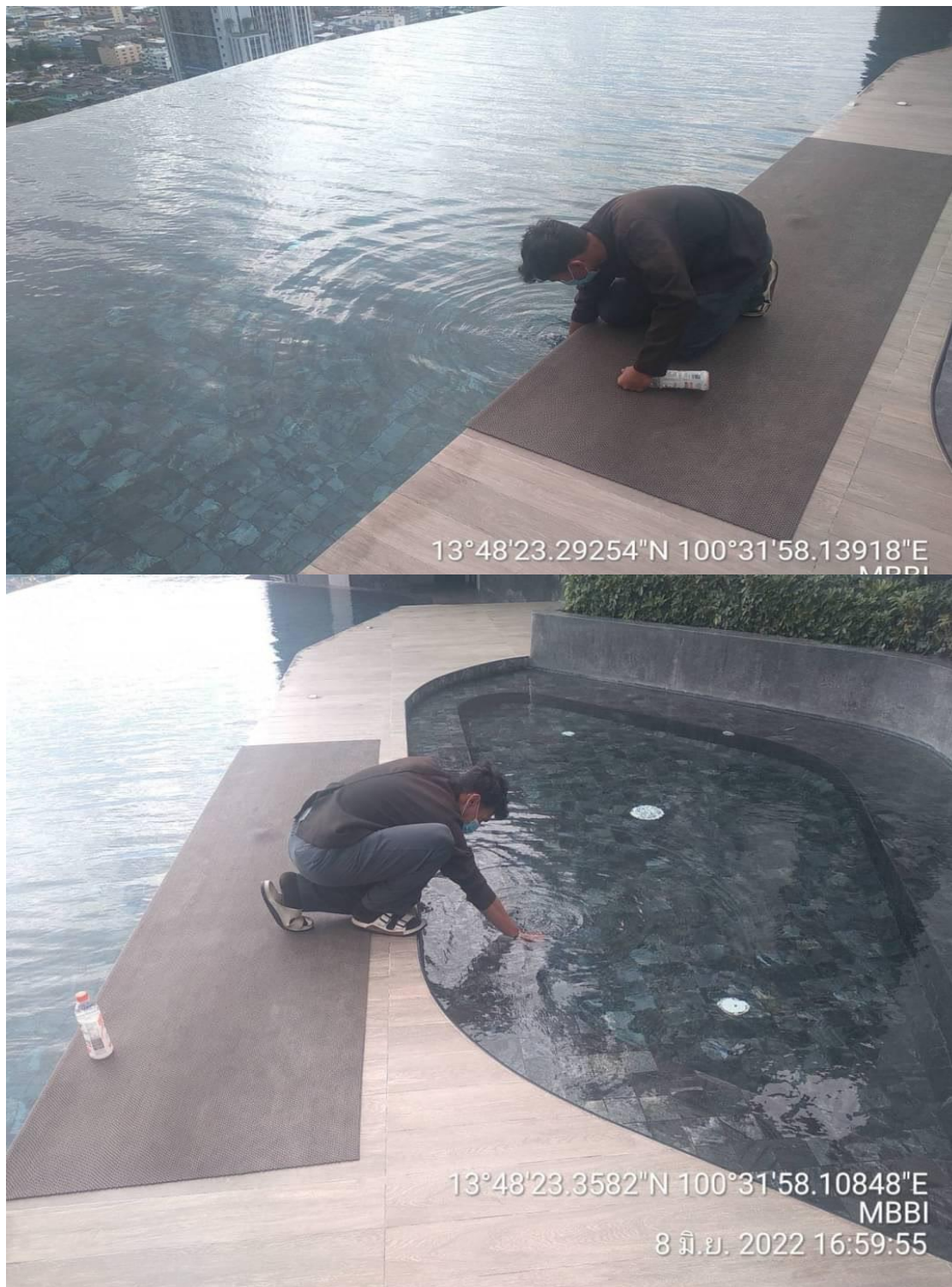
ภาพที่ 4.5-2 การตรวจวัด Total Coliform Bacteria (TCB) และ Fecal Coliform Bacteria (FCB) สระว่ายน้ำ
