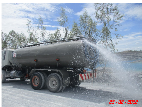
รูปที่ 2-15 การฉีดพรมน้ำบนเส้นทางขนแร่
