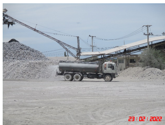
รูปที่ 2-15 การฉีดพรมน้ำบนเส้นทางขนแร่
