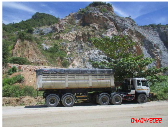
รูปที่ 2-20 การปิดคลุมผ้าใบรถบรรทุกแร่
