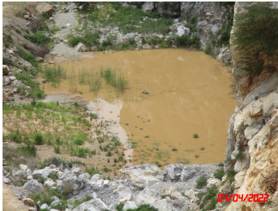
รูปที่ 2-6 บ่อรองรับน้ำฝน (Sump)
