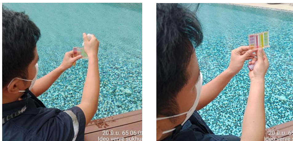
ภาพที่ 4.6.2 การตรวจวัด pH และ Free Chlorine สระว่ายน้ำ
