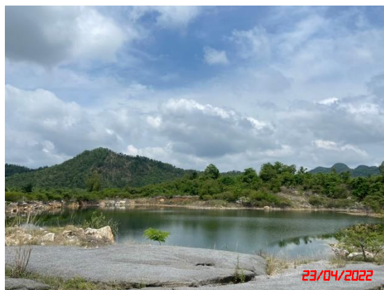
รูปที่ 2-16 บ่อรับน้ำ (Sump) บริเวณจุดต่ำสุดของพื้นที่หน้าเหมือง
