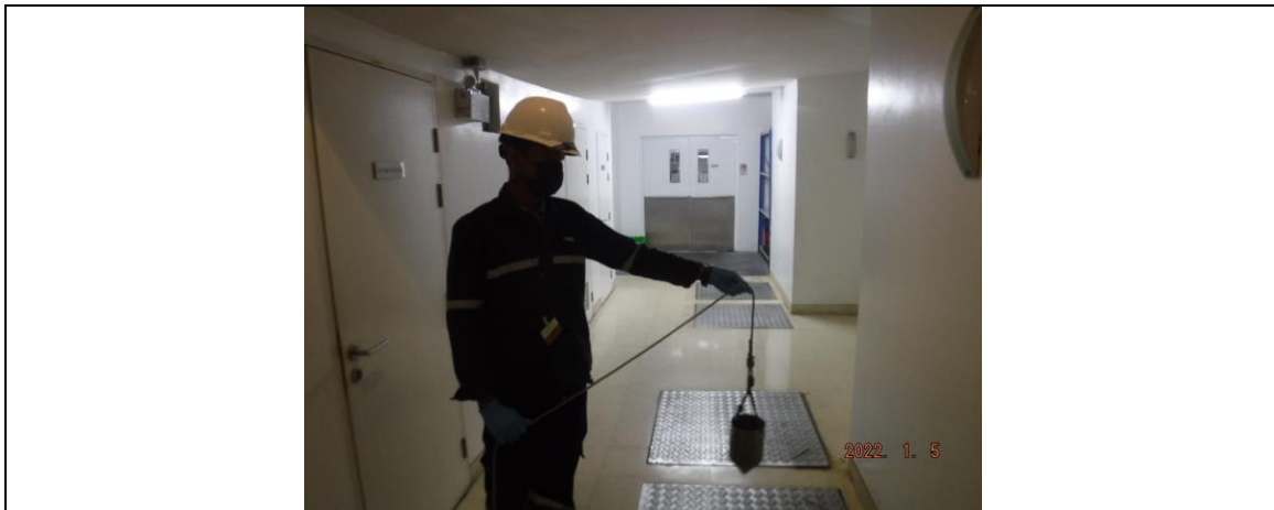
รูปที่ 3-2 การตรวจสอบคุณภาพน้ำทิ้ง บริเวณบ่อสูบน้ำทิ้ง
