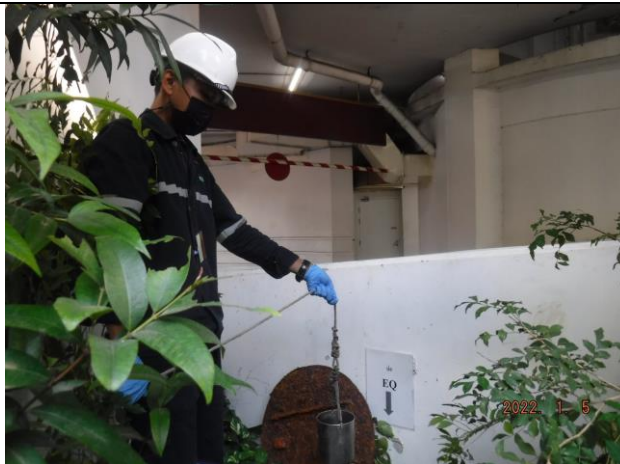
รูปที่ 3-1 การตรวจสอบคุณภาพน้ำทิ้ง บริเวณบ่อปรับสภาพน้ำ
