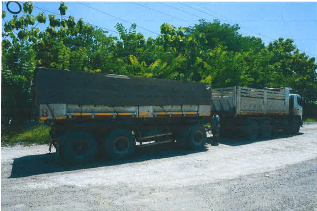
รูปที่ 4 แสดงการคลุมผ้าใบรถบรรทุกแร่ เพื่อป้องกันเศษหินหล่นบนถนนที่ใช้ร่วมกับชาวบ้าน
