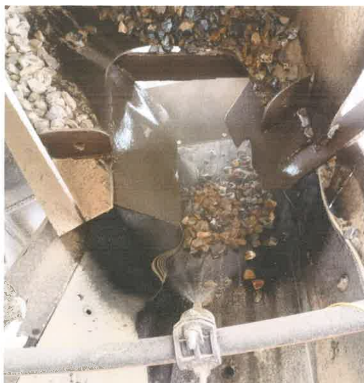
ภาพที่ 7 : ภาพแสดงฉีดพรมน้ำตามบริเวณเส้นทางขนส่งแร่พื้นที่โครงการ และภาพการนำน้ำจากขุมเหมืองมาใช้ในระบบสเปรย์น้ำภายในโรงโม่หิน
