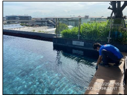
ภาพที่ 4.6-3 การตรวจวัด Total Coliform Bacteria (TCB) และ Fecal Coliform Bacteria (FCB) สระว่ายน้ำ
