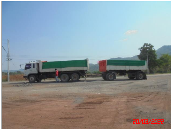
รูปที่ 2-14 การใช้ผ้าปิดคลุมกระบะรถบรรทุกก่อนออกนอกพื้นที่โครงการ
