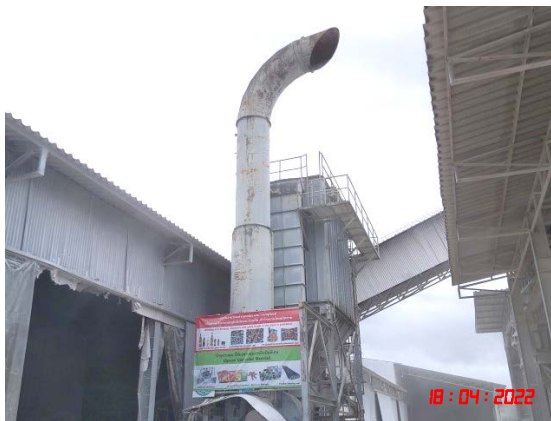
รูปที่ 2-11 ระบบกรองฝุ่นภายในโรงแต่งแร่
