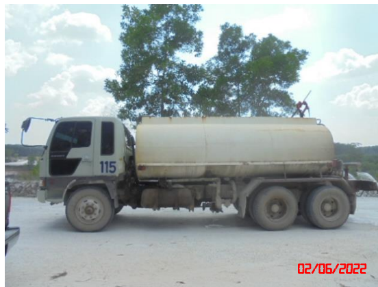
รูปที่ 2-16 ระบบการป้องกันฝุ่นละออง บริเวณโรงแต่งแร่
