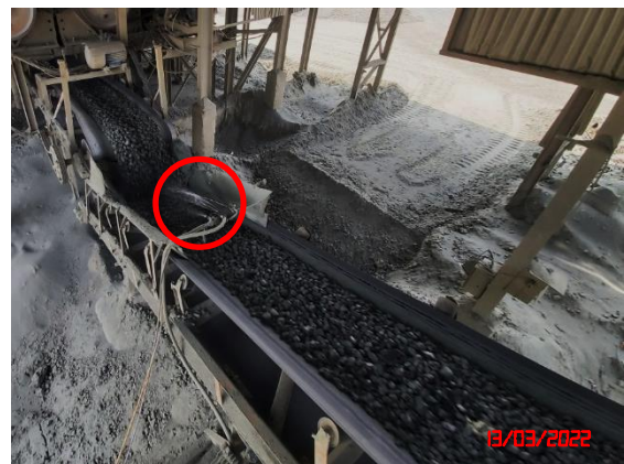
ระบบสเปรย์น้ำบริเวณกำเนิดฝุ่นละออง
