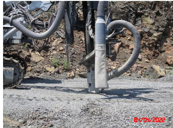
รูปที่ 2-7 เครื่องเจาะรูระเบิดที่มีอุปกรณ์เก็บฝุ่นติดไว้ที่หัวเจาะ
