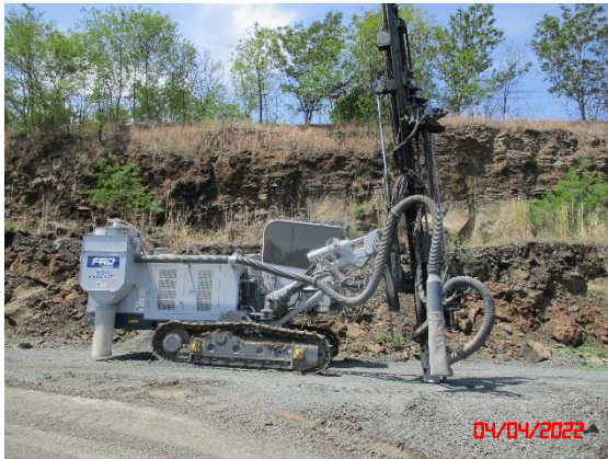
รูปที่ 2-7 เครื่องเจาะรูระเบิดที่มีอุปกรณ์เก็บฝุ่นติดไว้ที่หัวเจาะ
