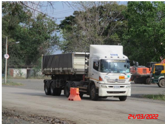
รูปที่ 2-12 การปิดคลุมกระบะรถบรรทุกและป้ายเตือนให้ปิดคลุมผ้าใบ
