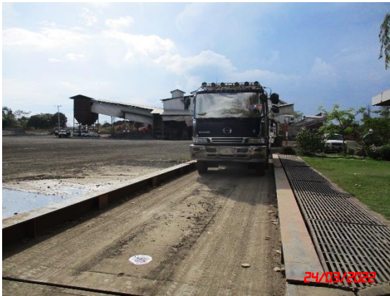
รูปที่ 2-25 จุดซังน้ำหนักรถบรรทุก และป้ายเตือนห้ามบรรทุกเกินน้ำหนักที่กำหนด
